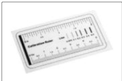
Kalibrační pravítko s dělením po 1 mm
